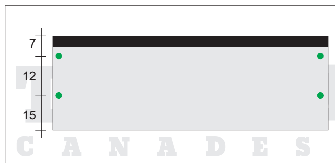
Fig. 5 - Chiodatura della prima fila di tegole
